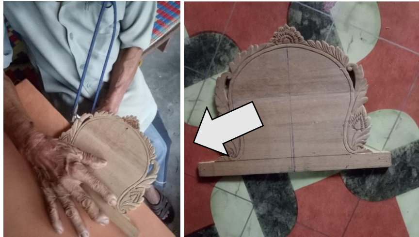
Gambar 5:Ukiran tapak. Anak panah menunjukkan lakaran ukiran menggunakan pensil.
