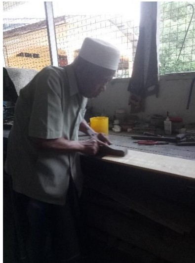
Gambar 4: Che Mud mendemostrasi cara mengetam kayu.
