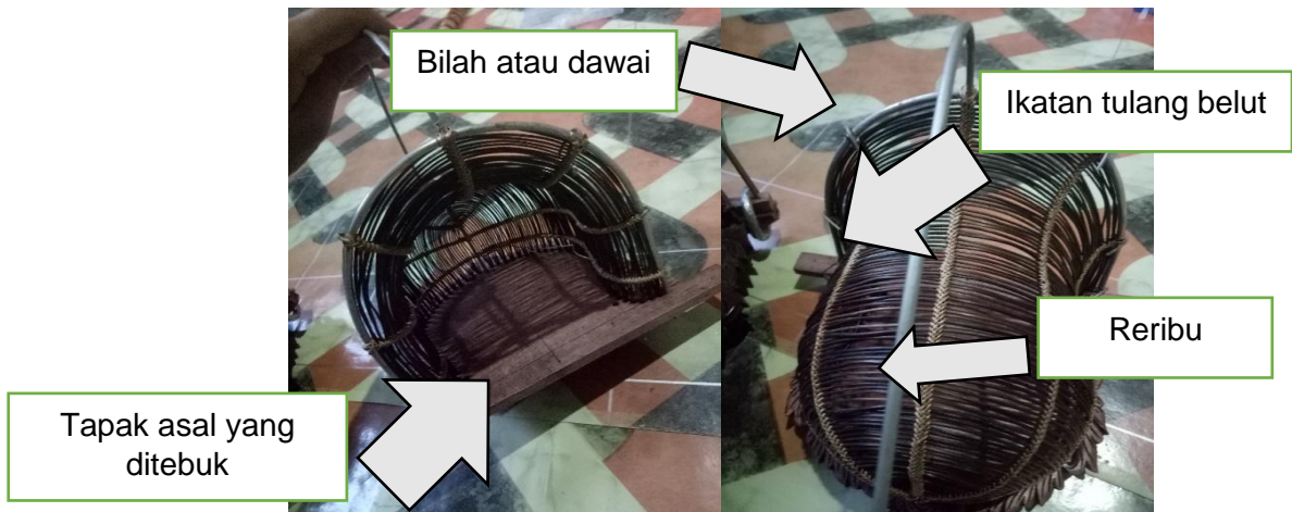
Gambar 8: Tapak yang telah ditebuk telah dimasukkan bilah dan reribu membentuk badan asas Jebak Puyuh.
