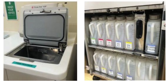
Gambarajah 2. Proses pemprosesan tisu mengambil masa selama 11 jam menggunakan SAKURA, VIP 6 Tissue Processor.
