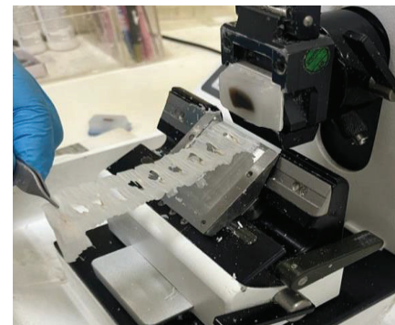
Gambarajah 4. Riben tisu terbentuk daripada pemotongan blok tisu paraffin dengan microtome .
