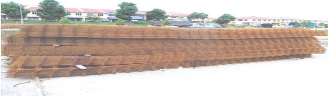
Gambarfoto 4.1: BRC bagi lantai bawah mengalami pengaratan tanpa perlindungan.
