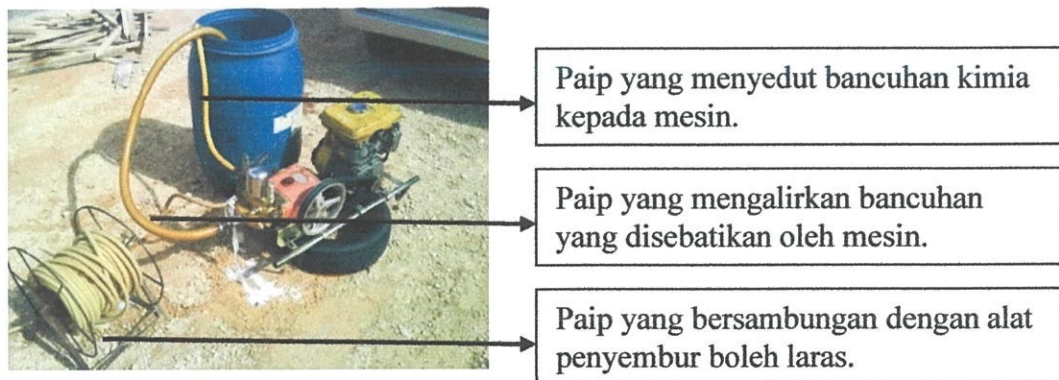
Gambarfoto 4.6 Komponen-komponen utama mesin tekanan berkuasa tinggi
