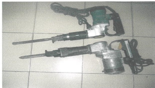
Gambarfoto 3.18: Mesin Pemecah Dan Pemahat konkrit
