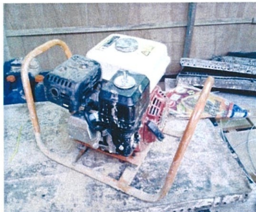
Gambar foto 3.25 Mesin vibrator
