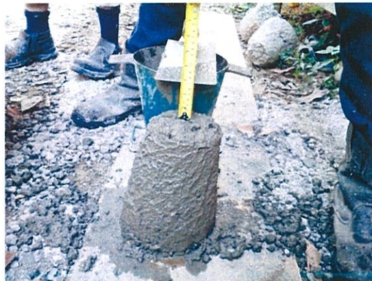
Gambar foto 3.22 Ujian kerincihan ( slum test )
