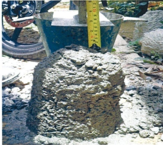
Gambar foto 3.36 Ujian kerincihan (slum test)
