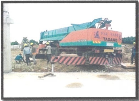
Gambar 3.26 & 3.27 : Kren bergerak hidraulik berkapasiti 45 tan
