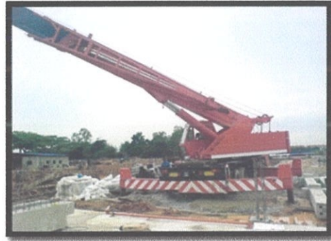
Gambar 3.26 & 3.27 : Kren bergerak hidraulik berkapasiti 45 tan
