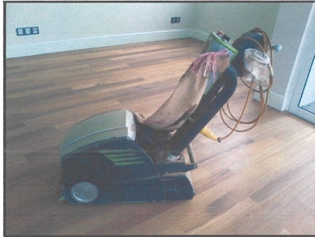
Gambar 3.21 Mesin pengempelas Foto Kredit: Asrul Asari (13 Mac 2012).
