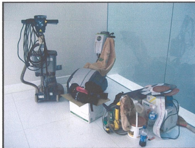
Gambar 3.28 Alatan untuk kerja pemasangan lantai kayu Foto Kredit: Asrul Asari (4 Januari 2012).
