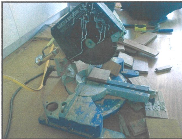
Gambar 3.39 Pemotongan puting kayu lantai Foto Kredit: Asrul Asari (4 Januari 2012).
