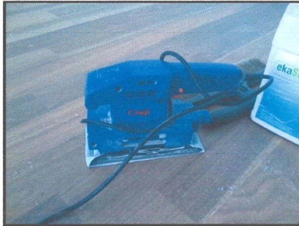
Gambar 3.54 Kerja mengempelas menggunakan saiz 150 Foto Kredit: Asrul Asari (13 Mac 2012).
