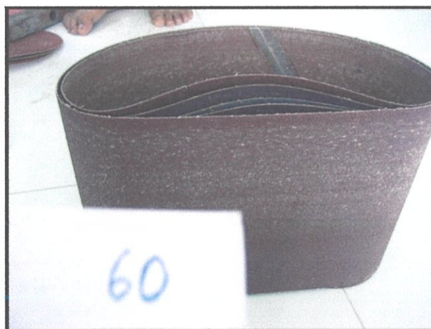
Gambar 3.46 Kertas pengempelas saiz 60 Foto Kredit: Asrul Asari (6 Januari 2012).
