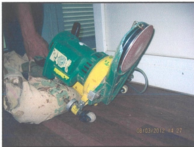
Gambar 3.22 Mesin pengempelas (kecil) Foto Kredit: Asrul Asari (13 Mac 2012).
