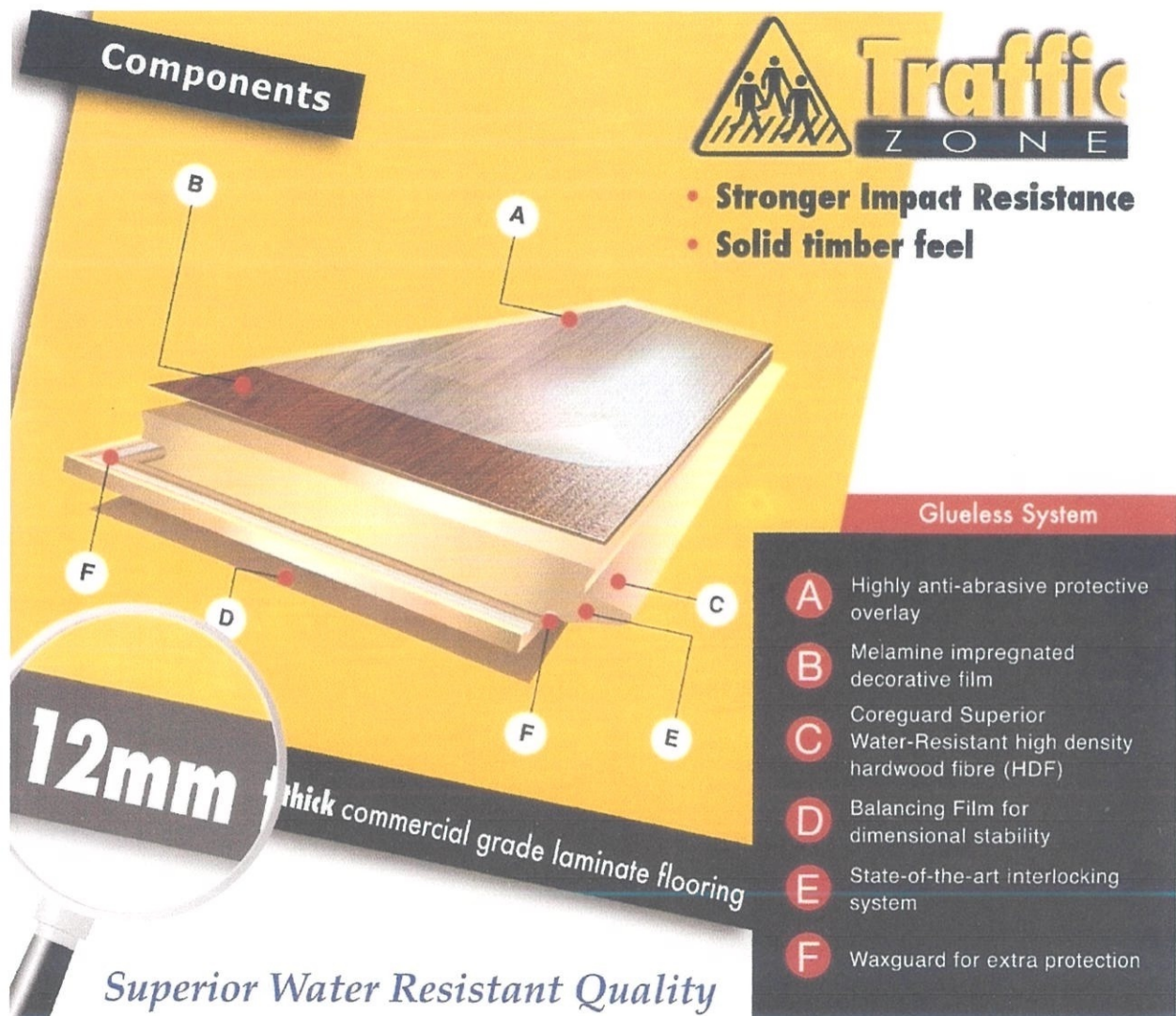
Rajah 3.5.3 – Komponen Lantai Kayu Laminat
