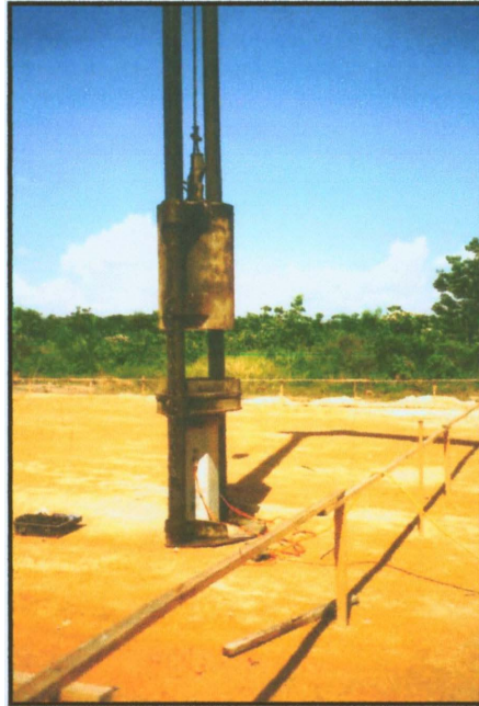
R.C6 UJIAN CERUCUK SEDANG DILAKUKAN KE ATAS CERUCUK BERNOMBOR A2, UJIAN SANGAT MUDAH KERANA HANYA MENGGUNAKAN SISTEM KOMPUTER (PROJEK PEMBINAAN TASKA, KG. BARU, SRI GADING BATU PAHAT JOHOR)
