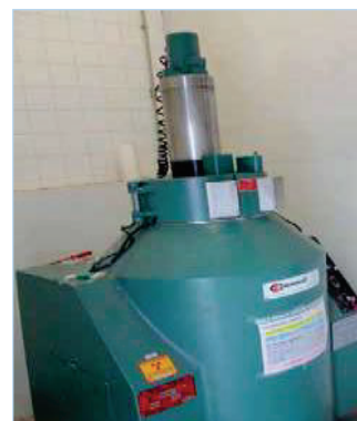
Gambar 4. (Atas) Mesin Biobeam: Sumber Cobalt-60 untuk akut-gamma.
