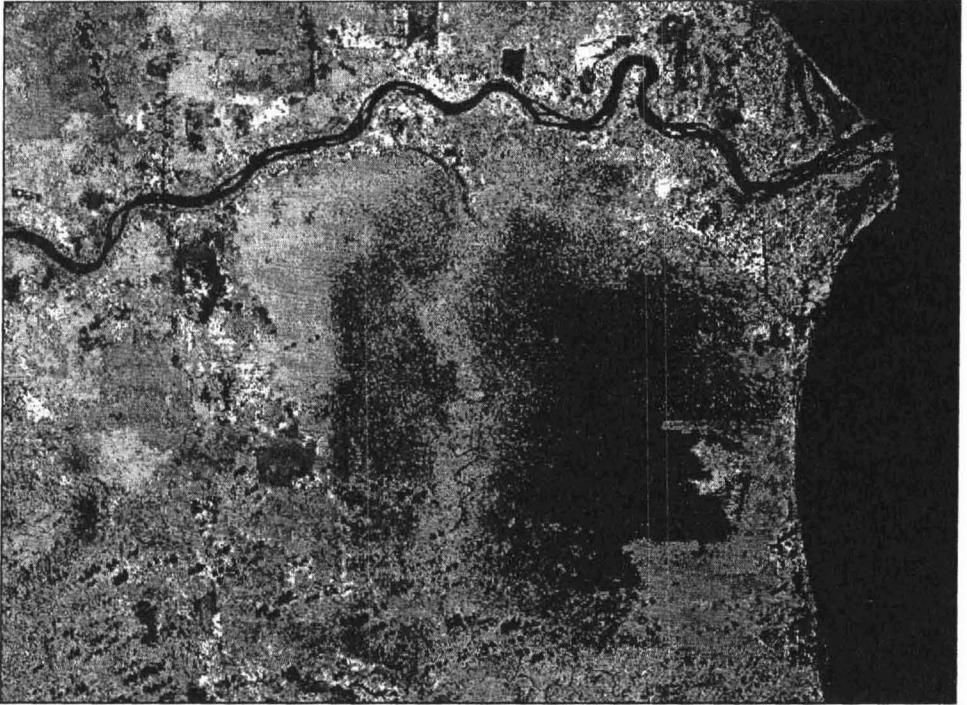
Rajah 1 Pengelasan “spectral” gunatanah oleh Jabatan Ukur dan Pemetaan. Imej satelit Landsat TM tahun 2001 menunjukkan variasi yang jelas untuk kawasan utara Kuantan, Pahang.
