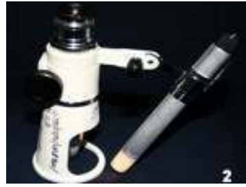
'Crack Detector' sejenis alat yang berfungsi mengesan dan mengukur keretakan pada bangunan. (Sumber: JWN)
