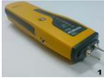
'Protimeter' sejenis alat yang biasa digunakan bagi mengukur kadar kelembapan pada bangunan
