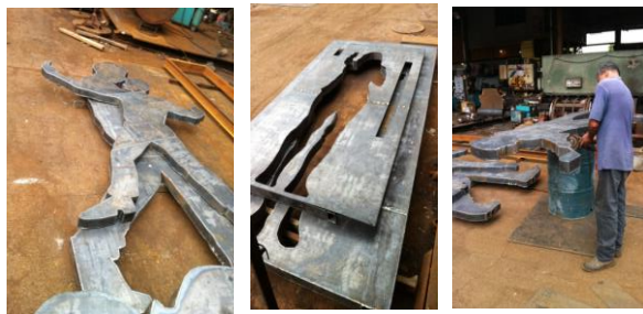
Rajah 9. Kerja penyudah menggunakan mesin Grinder dilakukan.
