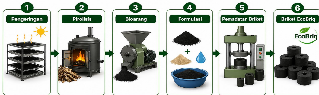
Rajah 1. Aliran proses pengeluaran briket bioarang EcoBriq
