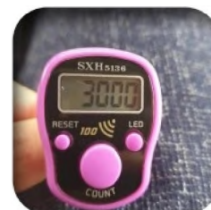
Gambar 2: Tasbih digital dengan fungsi bunyi "beep" setelah cukup kiraan 100
