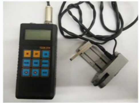
Alat MMM yang digunakan untuk mengenalpasti sifat besi di dalam konkrit
