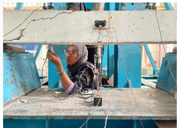
Pengesanan kecacatan pada rasuk menggunakan MMM
