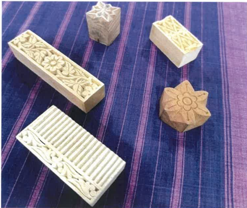
Rajah 8: Alat tekanan untuk membual seni telepuk
