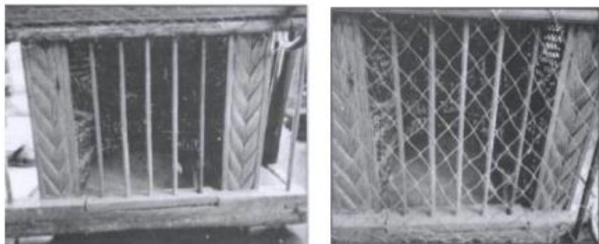
Gambar 17: Memasang jaring pukot pada bahagian depan
