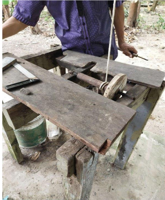
Gambar 4: Kayu bulat diletakkan pada Bendu untuk dilarik
