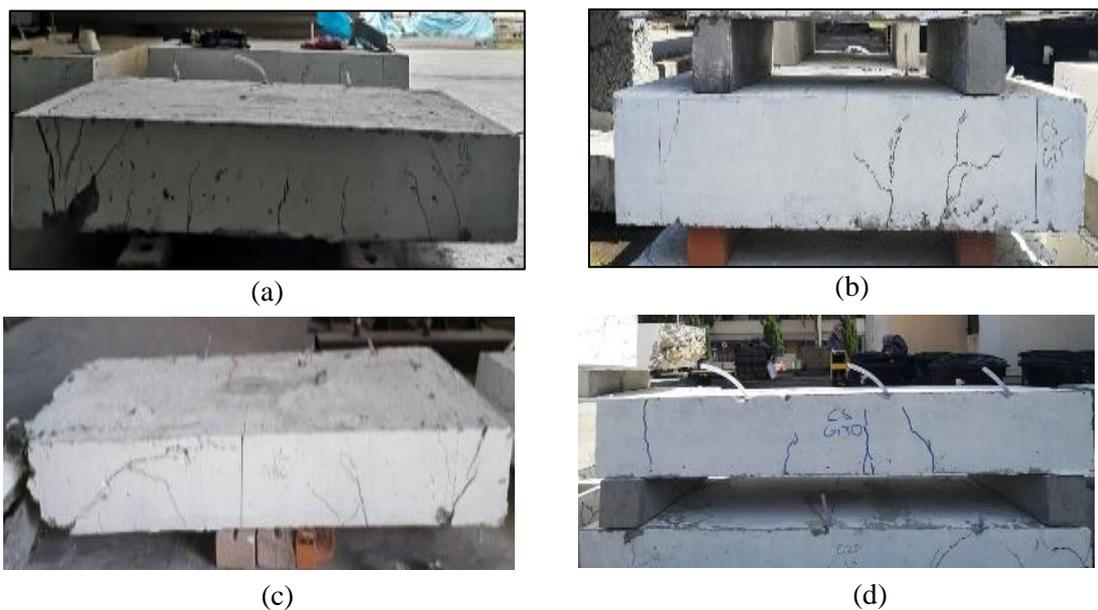
Figure 6: Crack Patterns (a) DL25; (b) CS25; (c) DL30; (d) CS30.
