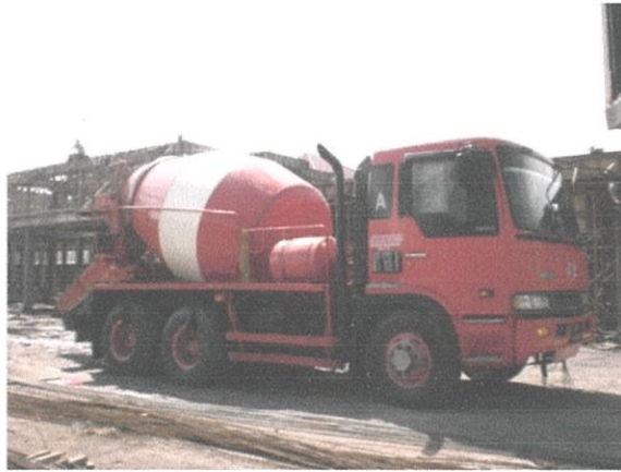
Gambar foto 4.1: penghantaran konkrit ke tapak pembinaan
