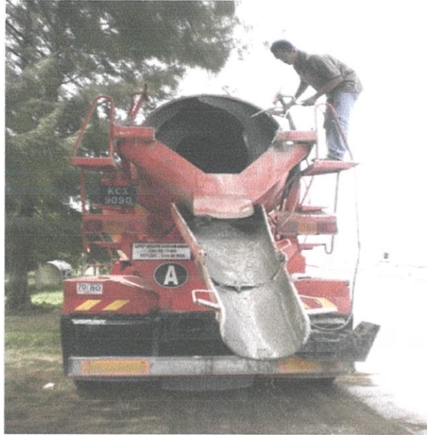
Gambar foto 4.2: Proses membersihkan sisa konkrit
