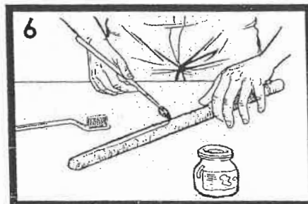
Slip (tanah cair) disapukan pada lingkaran yang telah digoreskan sebelum penyambungan dibuat.
