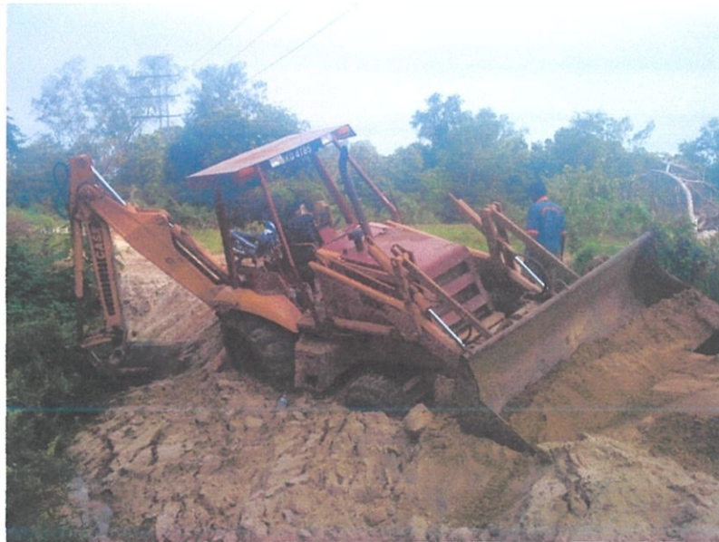
Gambar foto 5.1: Jentera tengelam disebabkan oleh struktur tanah tidak kukuh
