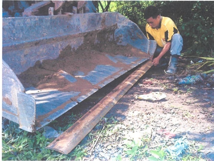
Gambar foto 4.13: Penambahan 'Cutting blade' pada backpusher
