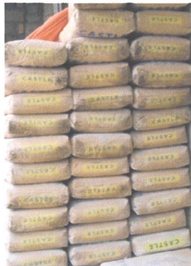
Gambarfoto 4.4 Penyimpanan simen secara bertingkat
