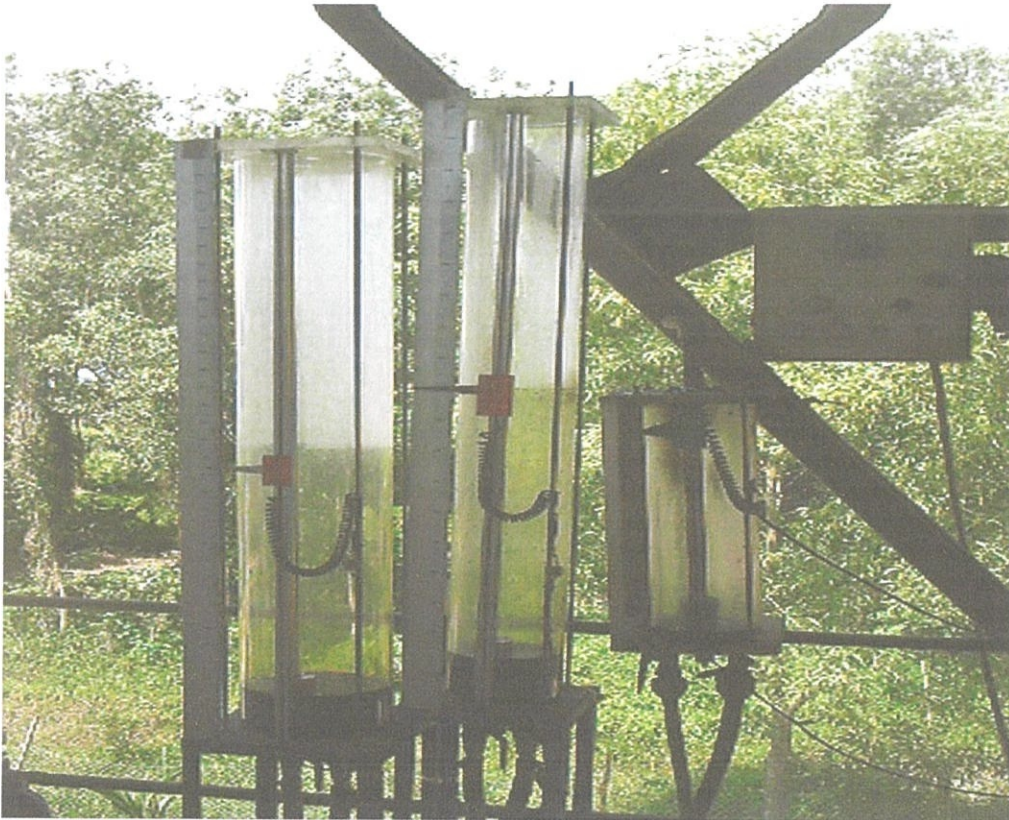
Gambar foto 4.5 Cecair kimia digunakan untuk bahan tambah konkrit
