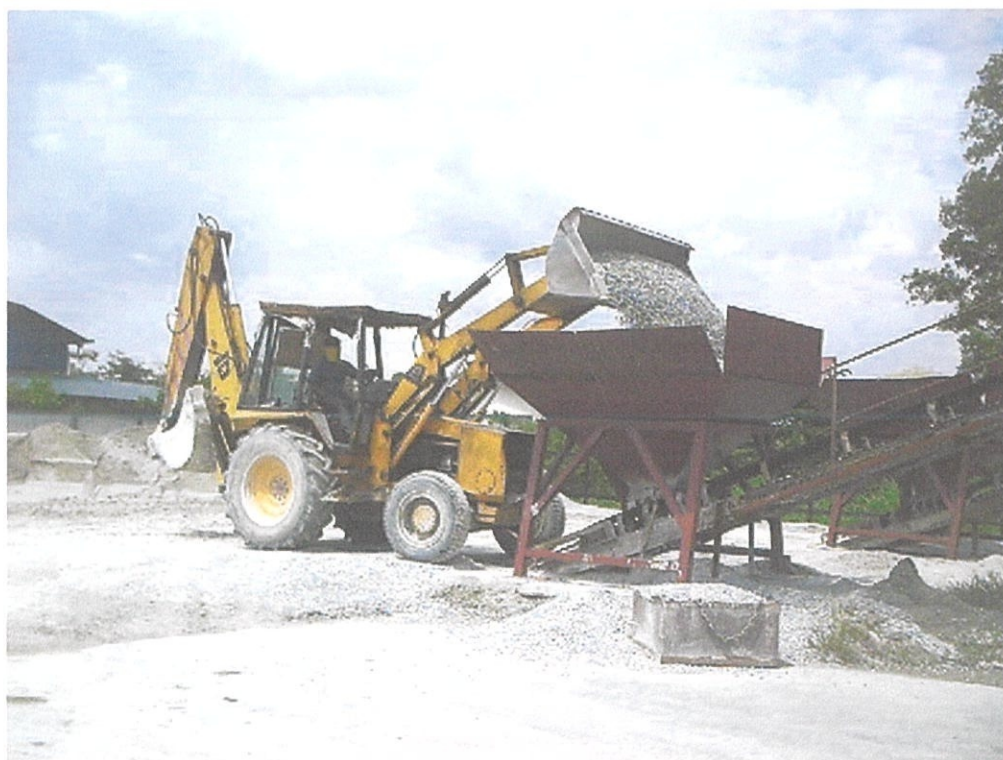
Gambar foto 4.2 Batu-baur dan pasir yang telah disaring dimasukkan ke dalam sebuah 'container' sebelum diangkut naik ke atas loji.
