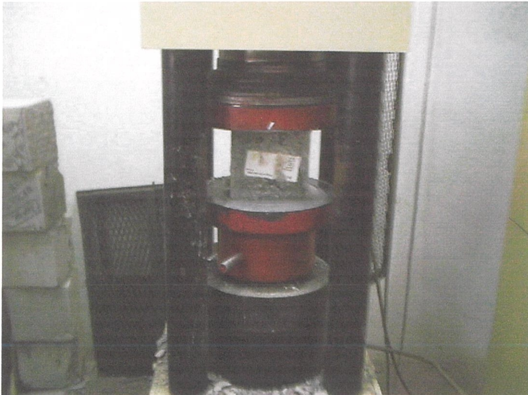
Gambar foto 4.12 Kiub konkrit sedang diuji di sebuah makmal bagi mengetahui tahap kekuatan konkrit untuk 7 hari dan 28 hari.
