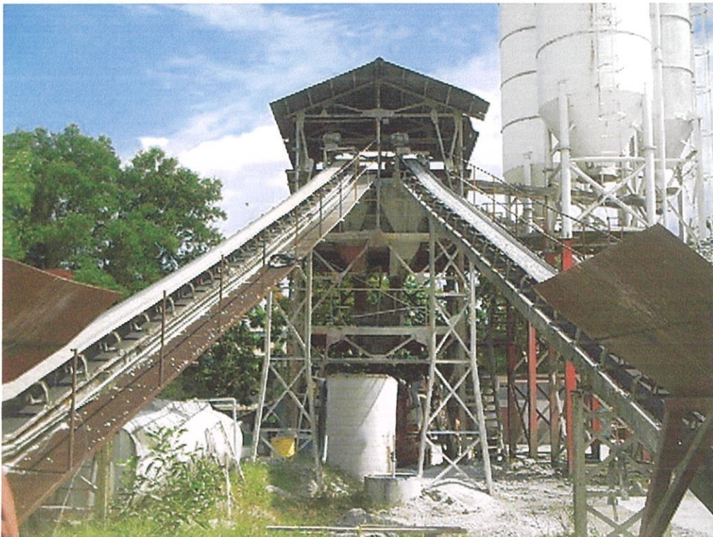
Gambar foto 4.3 Pasir dan batu-baur diangkut naik ke atas loji.
