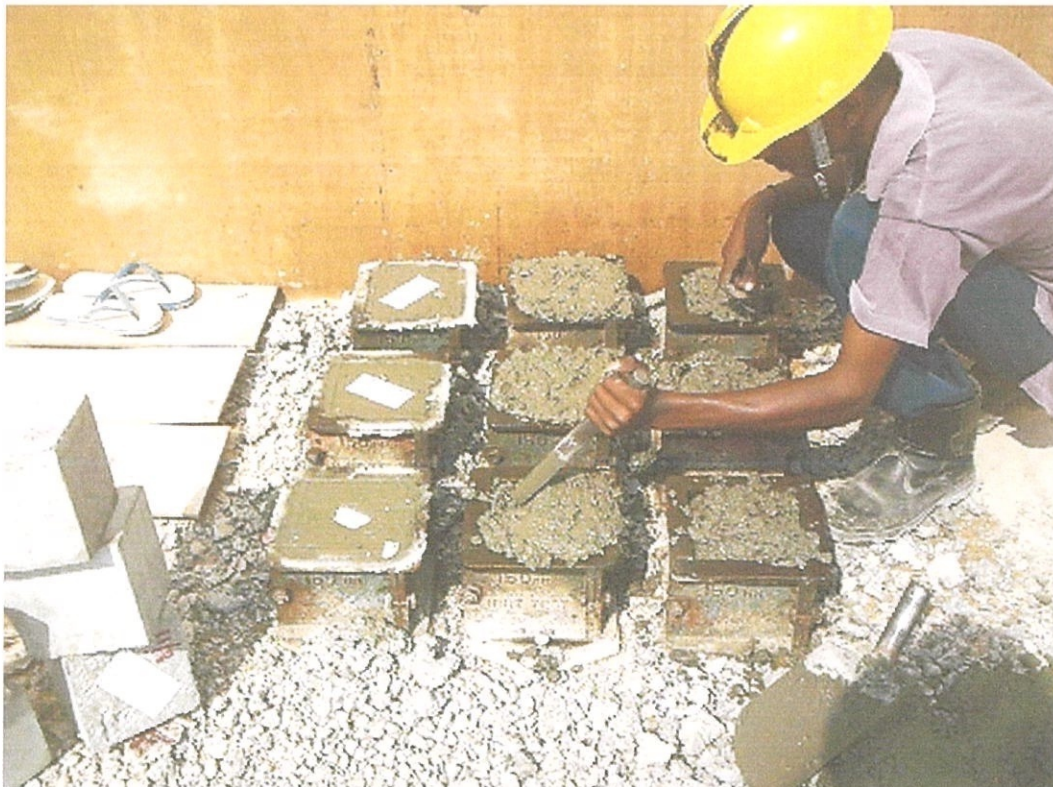
Gambar foto 4.10 Kerja-kerja menghentak bancuhan konkrit di dalam acuan perlu dilakukan dengan sekata agar konkrit tersebut betul-betul padat dan memenuhi setiap ruang.
