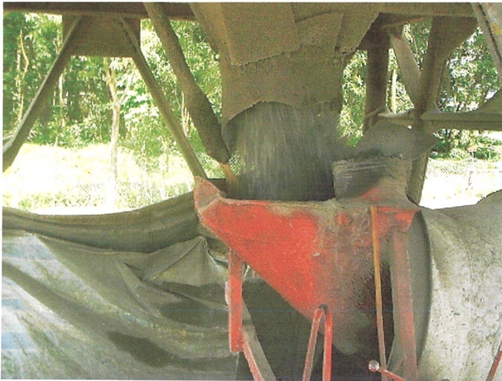
Gambar foto 4.6 Campuran konkrit kering dimasukkan ke dalam lori konkrit dan proses penggaulan dijalankan di dalamnya.
