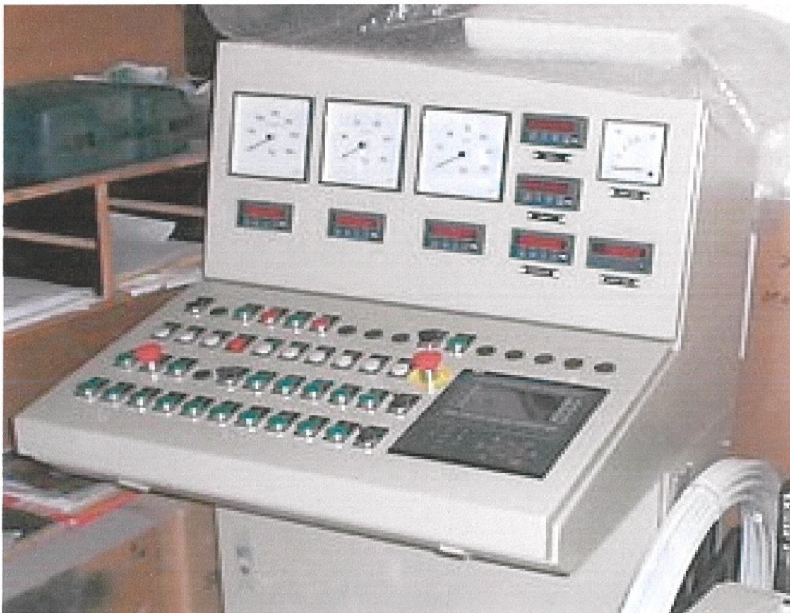
Gambar foto 3.0 Unit kawalan bahan digunakan untuk menyukat berat dan nisbah bahan yang diperlukan dalam penghasilan bancuhan konkrit.
