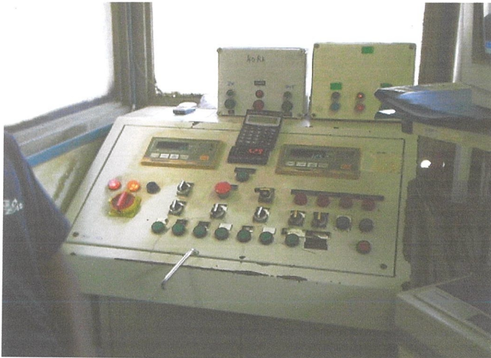
Gambar foto 4.4 Alat panel kawalan digunakan untuk menyukat bahan-bahan mentah konkrit.
