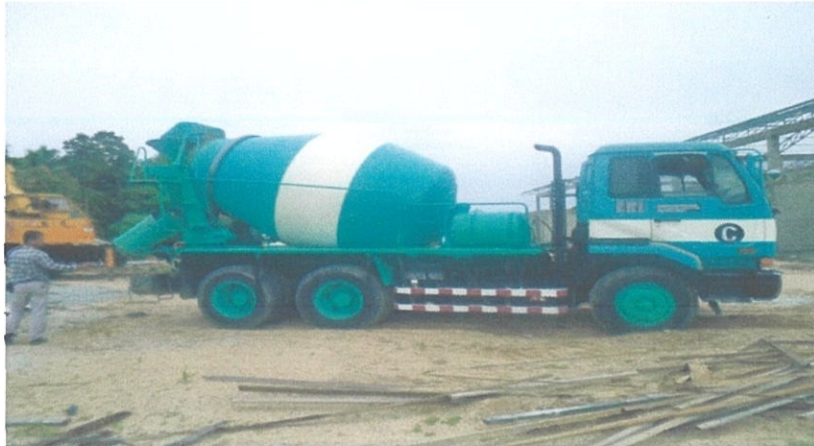
Gambar 3.9: Lori Konkrit Bancuh Siap yang digunakan untuk kerja konkrit dalam kuantiti yang banyak.
