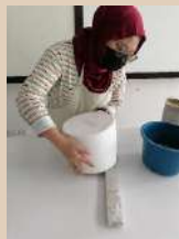
Gambar 4: Proses pengeringan slip di dalam acuan
