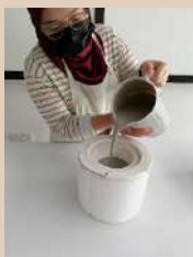
Gambar 2: Proses tuangan slip ke dalam acuan
