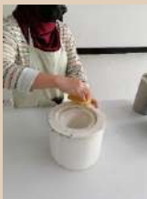
Gambar 1: Proses penyediaan acuan untuk tuangan slip
