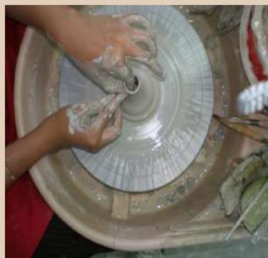
Ilustrasi diatas menunjukkan penghasilan spout menggunakan mesin lempar alin.
