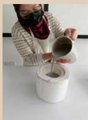
Gambar 2: Proses tuangan slip ke dalam acuan
