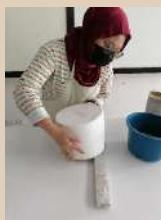
Gambar 4: Proses pengeringan slip di dalam acuan
