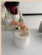
Gambar 1: Proses penyediaan acuan untuk tuangan slip
