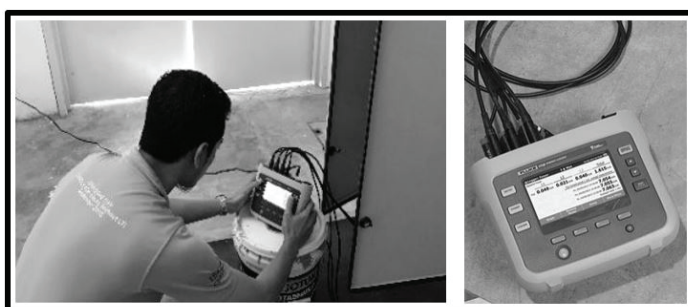
Rajah 6: Penggunaan “Power Data Logger” oleh Pembantu Penyelidik di Tapak Kajian untuk Merekod Bacaan Tenaga Elektrik Harian (Sumber: Penyelidikan Penulis)
