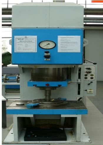
Figure 10: Sheet metal bending machine VEB Werkzeug PYE 160S.
