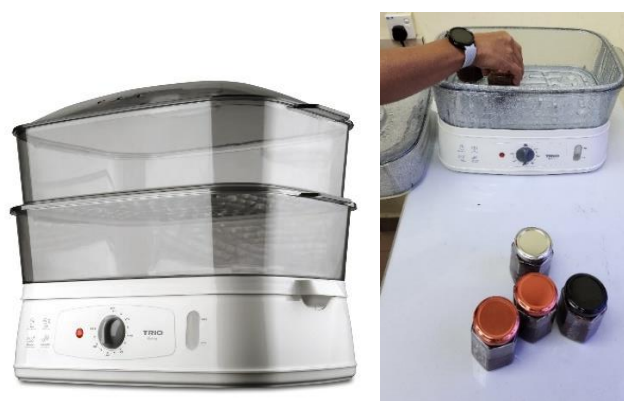
Rajah 3.4: Kukus elektrik yang digunakan bagi menggantikan penggunaan mesin retort untuk mensteril SBR
