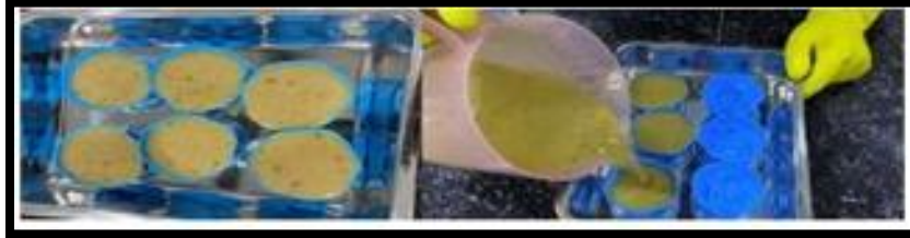
Rajah 5: Bancuhan yang telah siap proses Trace akan dituang kedalam acuan dan dicampur dengan ekstrak Roselle yang telah dikisar
