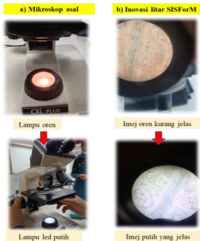
Rajah 6. Imej dari a) mikroskop asal dengan b) inovasi litar SISForM.
