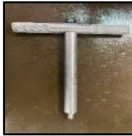
Gambarajah 3. Langkah ketiga membina pemegang atau perengkuh menggunakan mesin larik dengan proses membunga dan membenang luar.
