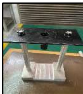
Gambarajah 2. Langkah kedua mebina bahagian badan dan tapak projek menggunakan mesin gerudi, mesin larik, mesin kisar, mesin kimpalan serta pemasangan menggunakan bolt dan nut .
