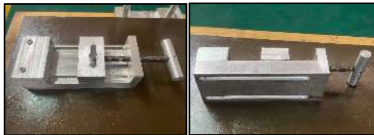
Gambarajah 4. Langkah keempat membina ragam projek menggunakan mesin larik dan mesin kisar serta pemasangan menggunakan skru dan juga pin.
