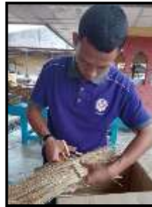
Langkah 2: Memotong serat batang pisang dengan berukuran 50 mm panjang
