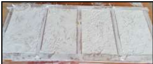
Langkah 5: Proses pengeringan panel komposit selama 48 jam
