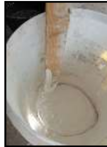
Langkah 3: Membancuh gypsum, air dan serat batang pisang sehingga sehati
