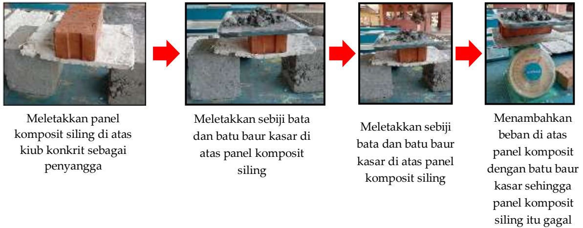
Rajah 3. Langkah pengujian ketahanan beban
