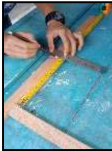
Langkah 1: Membuat kotak bentuk berukuran 300 mm x 210 mm x 10 mm
