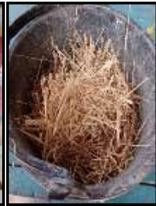
Langkah 2: Memotong serat batang pisang dengan berukuran 50 mm panjang
