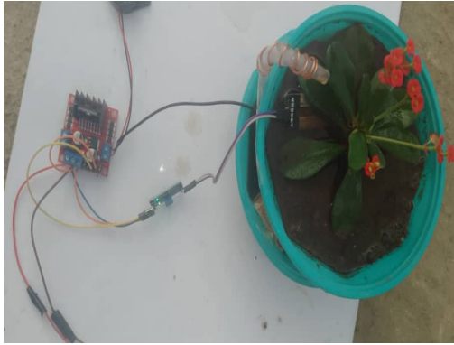
Fig. 14. Water Supply Module
