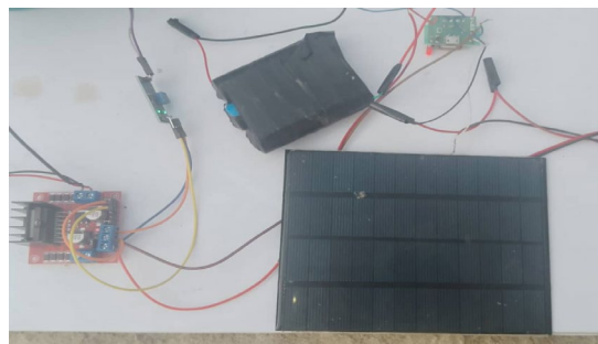
Fig. 13. Power Supply Module
