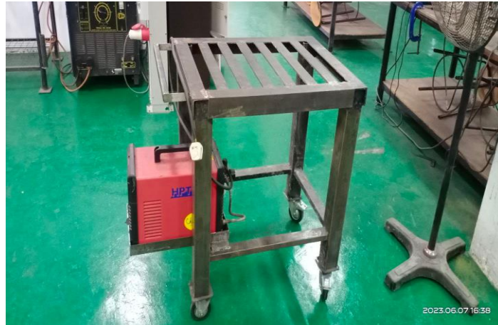
Rajah 2: Gambar selepas inovasi telah menjadi produk Easy Movable Bench Plasma Cutter Machine yang menyelesaikan masalah di Bengkel Kimpalan
