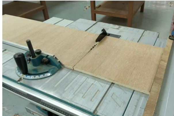
Rajah 2 : kayu pallet asal sebelum dibelah (foto sebelah kiri) dan kerja belahan plywood untuk penutup sarang Hive Kelulut (foto kanan)
