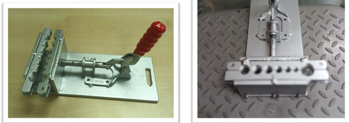
Rajah 10 : Ragum Paip Kuprum Mini yang telah siap
