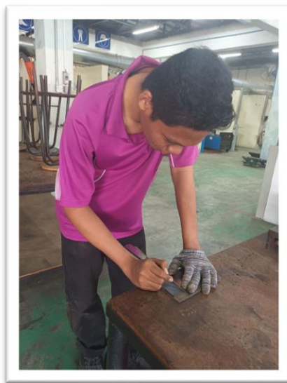
Rajah 4: Proses penandaan dan pengukuran bahan logam
