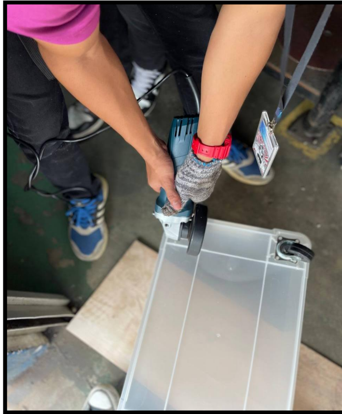
Rajah 2: Menebuk lubang pada bahagian bawah
