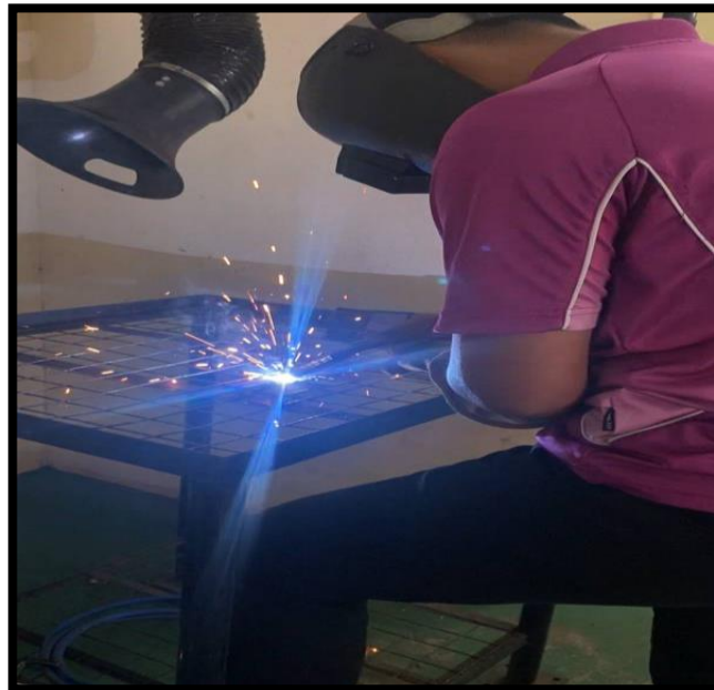
Rajah 6: Langkah 4 Weldingkan ke semua bahan yang sudah dipotong
