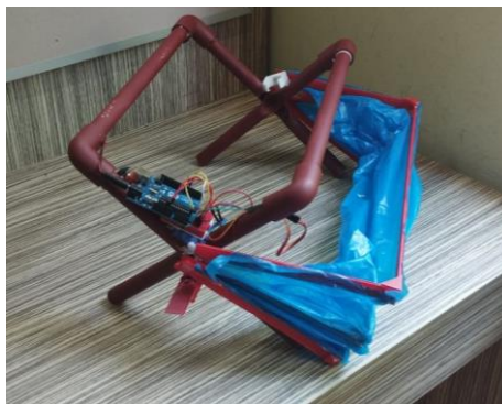
Rajah 1: Prototaip ampaiian pakaian pintar menunjukkan fungsi sensor dan bumbung.
