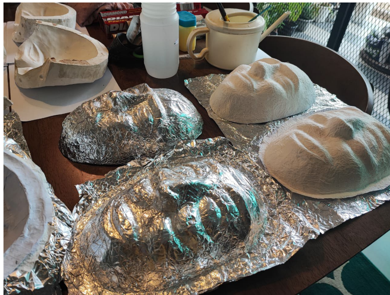
Rajah 3 : Penghasilan topeng menggunakan acuan Plaster of Paris
