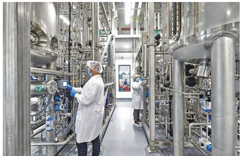
Gambar 3: Bioreaktor daging makmal di Emeryville, California yang dimiliki oleh syarikat Upside Foods. (Sumber: Blois, 2023)
