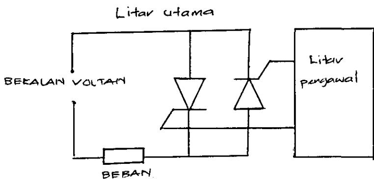
Litar ini merupakan suatu model alat pengawal voltan yang boleh digunakan untuk mengawal voltan pada beban yang mempunyai kadar atau 'rating' yang rendah misalnya pada kompenan kompenan elektronik dan juga pada kadar yang tinggi contohnya dalam sistem penghantaran kuasa elektrik. Ia juga boleh digunakan untuk sistem satu fasa atau tiga fasa.
