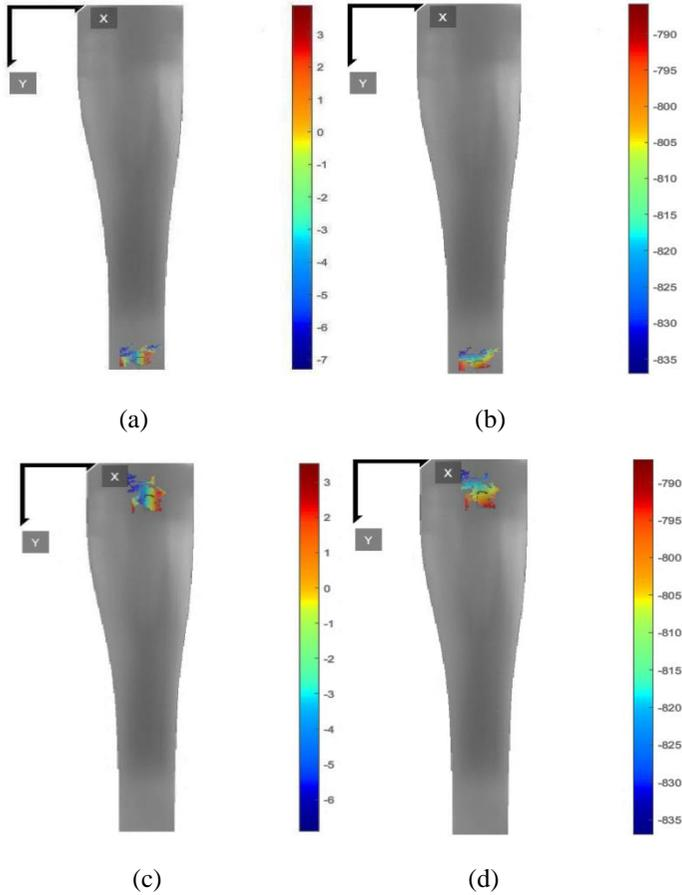
Figure 3: Lagrangian (a)  $u$ -displacement (b)  $v$ -displacement; Eulerian (c)  $u$ -displacement (d)  $v$ -displacement of blown film marked with black marker pen ink
